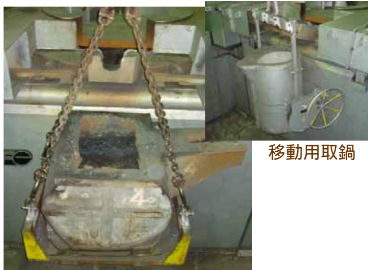
注湯取鍋直出しによる電力節減(3月)
